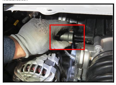
4. Sensor (Schlüsselweite 27) inkl. Halteblech demontieren.
